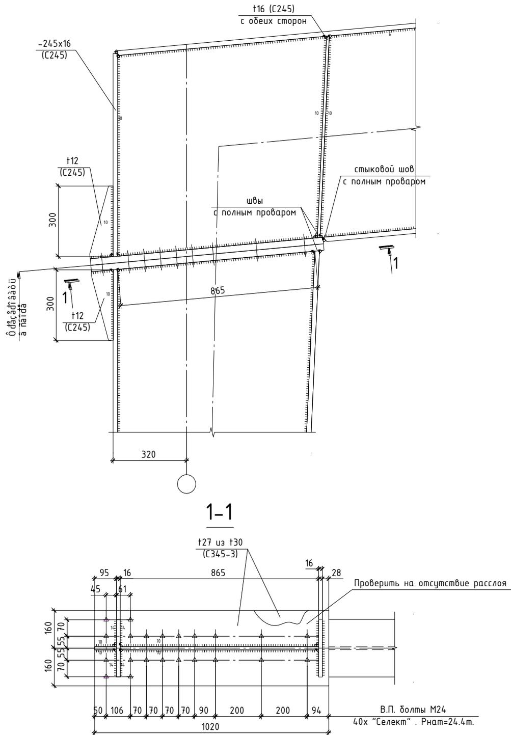
**Рис. 15 Монтажный стык ригеля с колонной.**
